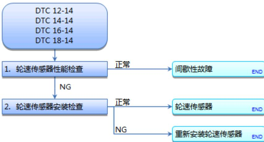
**DTC 12-14:** 右前轮速传感器安装错误**DTC 14-14:** 左前轮速传感器安装错误**DTC 16-14:** 右后轮速传感器安装错误**DTC 18-14:** 左后轮速传感器安装错误注意: [进行故障排除前, 查看一般故障排除信息。](#)
